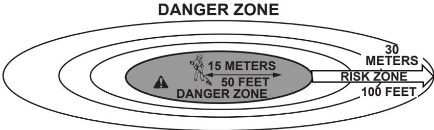
**NO PERSON EXCEPT OPERATOR IS ALLOWED IN 15 METER RADIUS\* DANGER ZONE. EYE, EAR, FACE, FOOT, LEG AND BODY PROTECTION MUST BE WORN BY OPERATOR. PERSONS IN ZONE OF RISK BEYOND DANGER ZONE MUST WEAR EYE PROTECTION.**
