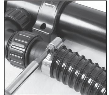
Installation d'un collier de serrage en acier inoxydable
