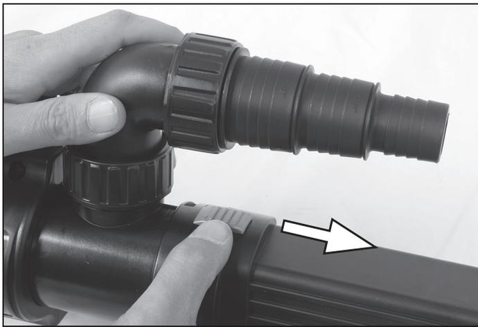
3. Tournez le ballast dans le sens antihoraire d'environ 1/2 po pour le déverrouiller et sortez-le ballast avec précaution en le faisant glisser avec la douille à quartz attachée.
